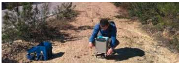
Techniker bei der Durchführung einer gravimetrischen Messung mittel Gravimeter (CG-5)
